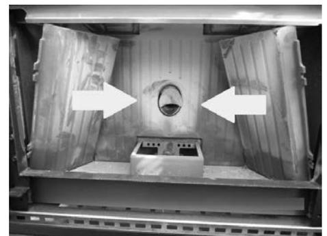
*Fig. 36 - Extracción de las paredes laterales de hierro fundido*
