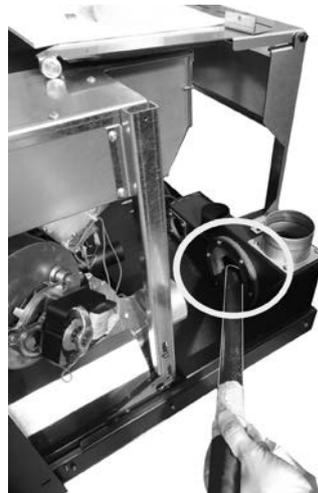
*Fig. 40 - Limpieza del canal de humo*
