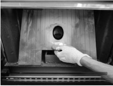
*Fig. 37 - Extracción de la pared central de hierro fundido*
